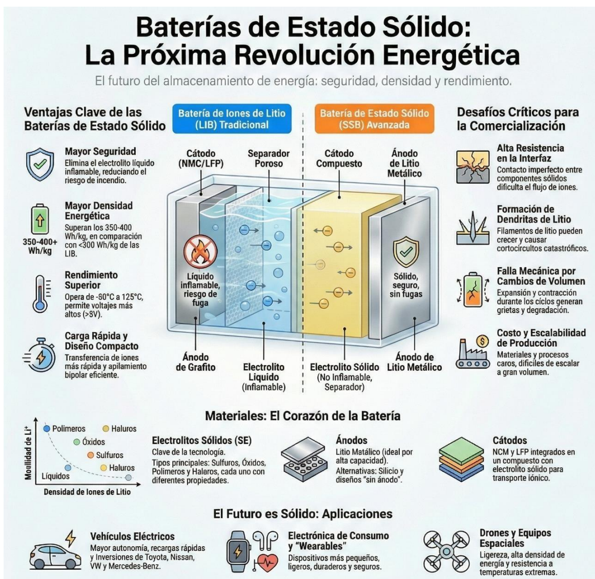
Figura 2. Comparativa conceptual entre baterías de ion-litio convencionales y baterías de estado sólido, destacando diferencias en arquitectura interna, materiales y principales ventajas y desafíos tecnológicos.
