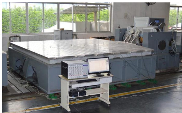
Imagen 10. Equipo de vibración electrodinámico con sistema de adquisición multicanal.
